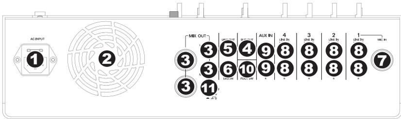
1. **NETZEINGANG** - Verbinden Sie das mitgelieferte Netzkabel mit diesem Eingang und das andere Ende des Kabels mit einer Stromquelle. Achten Sie darauf, dass der NETZSCHALTER auf der Oberseite auf "off" steht, wenn Sie das Kabel anschließen oder abstecken.
