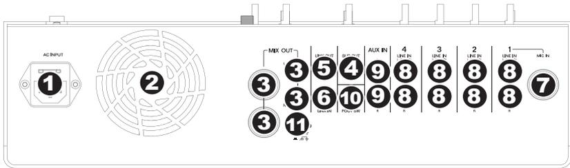
1. **ENTRÉE D'ALIMENTATION** – Branchez le câble d'alimentation inclus à cette entrée et branchez l'autre extrémité à une source d'alimentation électrique. Assurez-vous que l'interrupteur d'alimentation est réglé sur « Off » lorsque vous branchez/débranchez le câble d'alimentation.
