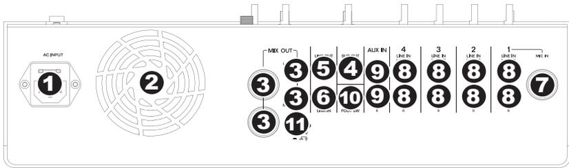
1. **INGRESSO DI ALIMENTAZIONE** – Collegare il cavo di alimentazione in dotazione a questo ingresso, quindi collegare l'altro capo del cavo stesso ad una sorgente di alimentazione. Assicurarsi che l'INTERRUTTORE DI ALIMENTAZIONE a livello del pannello superiore sia su "off" al momento di collegare e scollegare il cavo.
